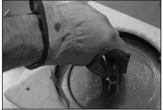
Schéma 7.4 Retirez le capuchon d'évent
