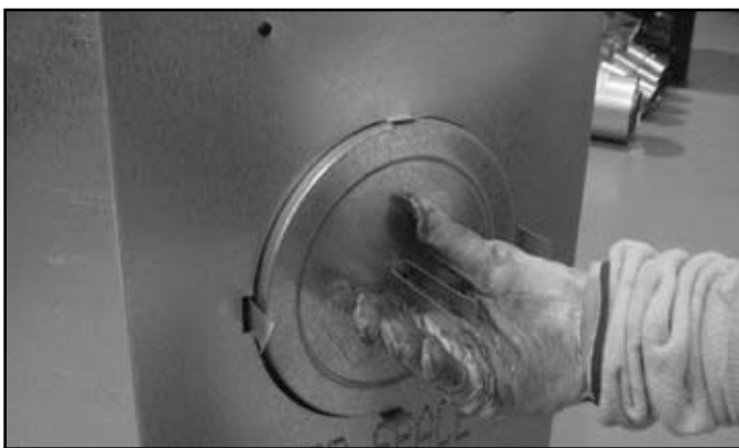
Schéma 7.9 Pliez la bande de retenue en métal
