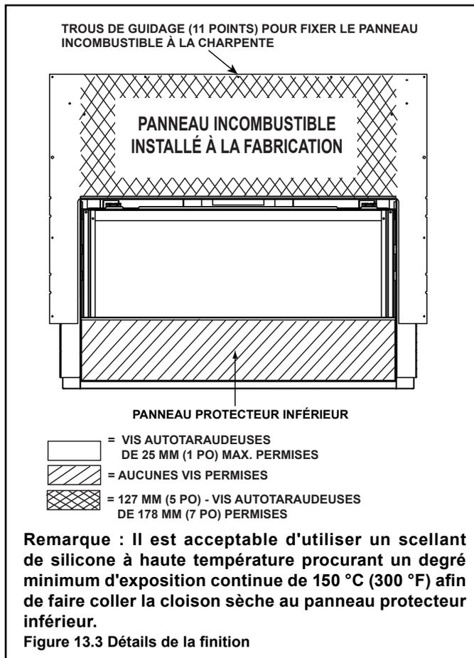
**ATTENTION! Risque de dommage à la vitre et de coupures!** NE PAS percer ou installer de vis ou d'attaches dans le panneau protecteur inférieur. Les vis pointues ou extrémités des attaches pourraient pénétrer et briser la vitre, ou causer des coupures.
