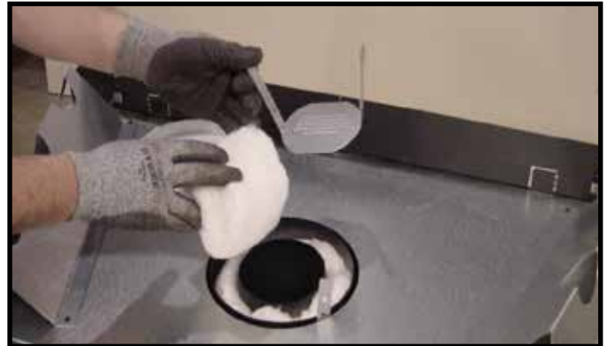
Figure 9.4 Jetez le panier isolant et l'isolant blanc du centre de tuyau du conduit.
