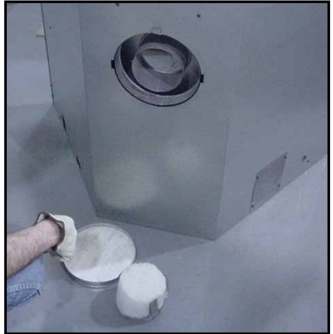
Figure 9.10 Jetez le capuchon plombé, retirez et jetez le panier d'isolant.
