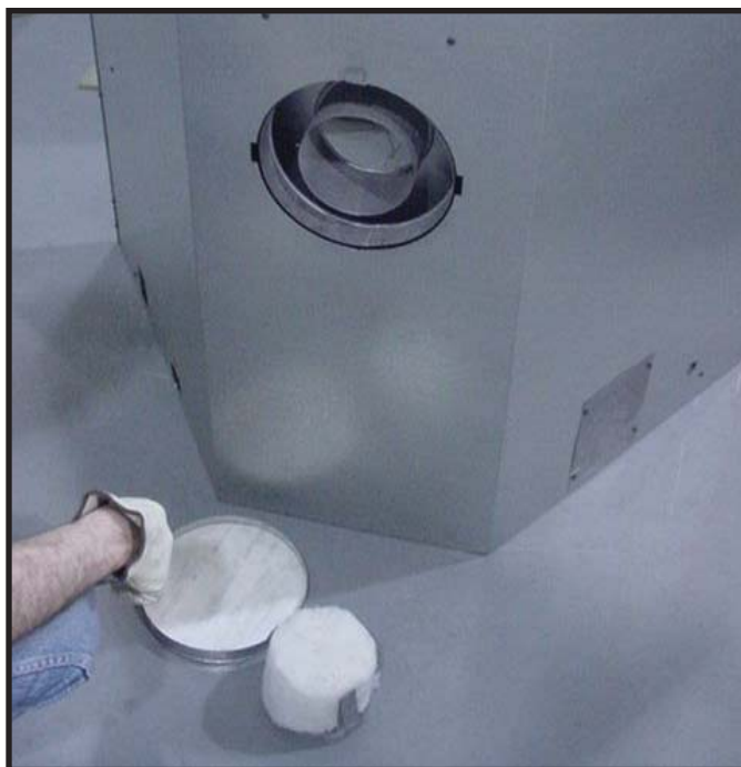
Figure 9.10 Jetez le capuchon plombé, retirez et jetez le panier d'isolant.
