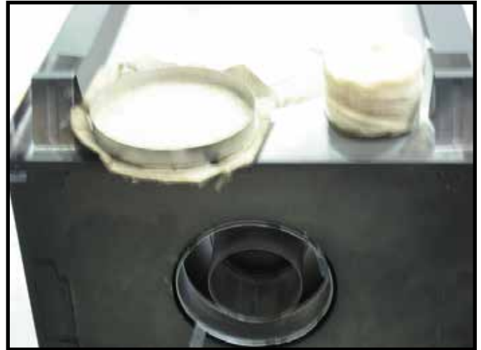
Figure 9.7 Jeter le capuchon plombé, le bouchon isolant et le panier d'isolation.
