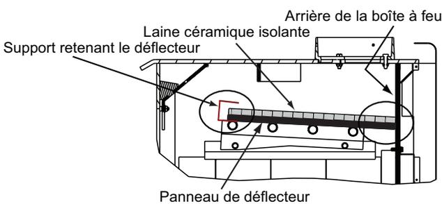
La laine céramique isolante et le panneau du déflecteur **DOIVENT** être en contact avec l'arrière de la boîte à feu et même l'un avec l'autre à l'avant.
