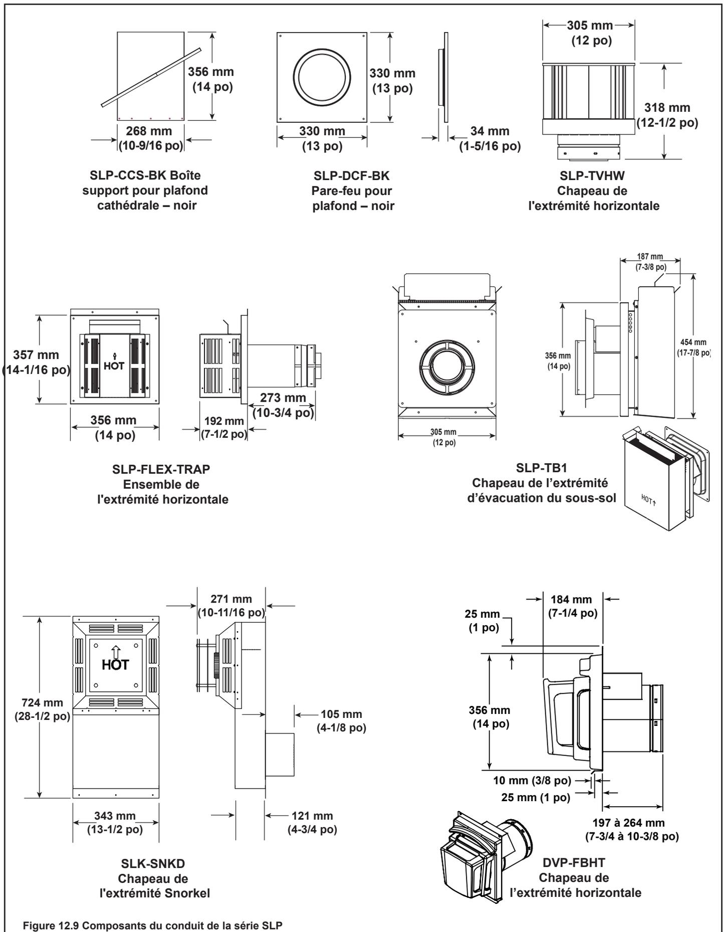
Figure 12.9 Composants du conduit de la série SLP
