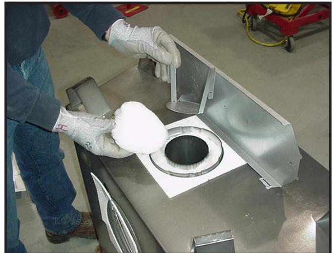
**Figure 6.5** Retirez le panier d'isolation et l'isolant blanc du centre du conduit d'évacuation des gaz.
