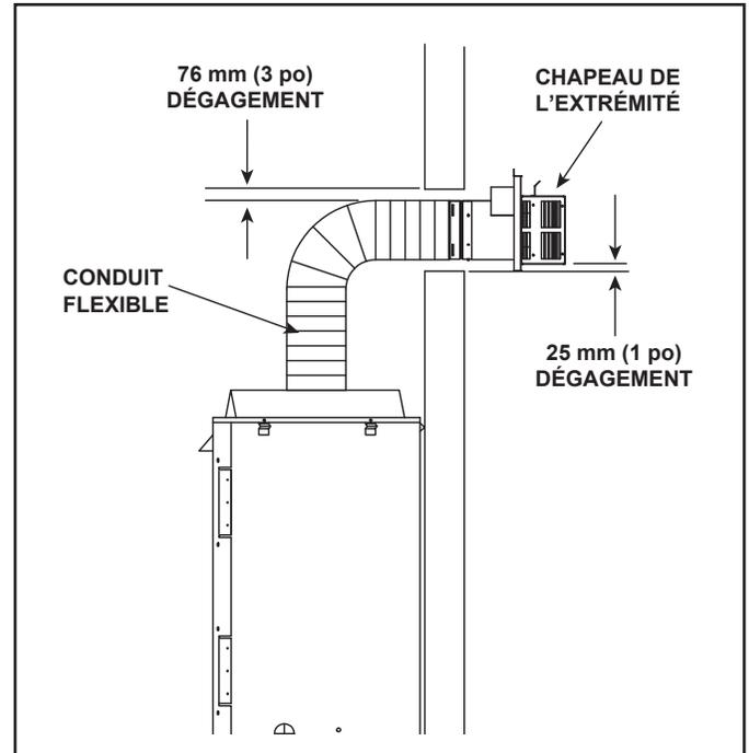
Figure 4.8 Tuyau flexible d'évacuation - Foyer générique montré
