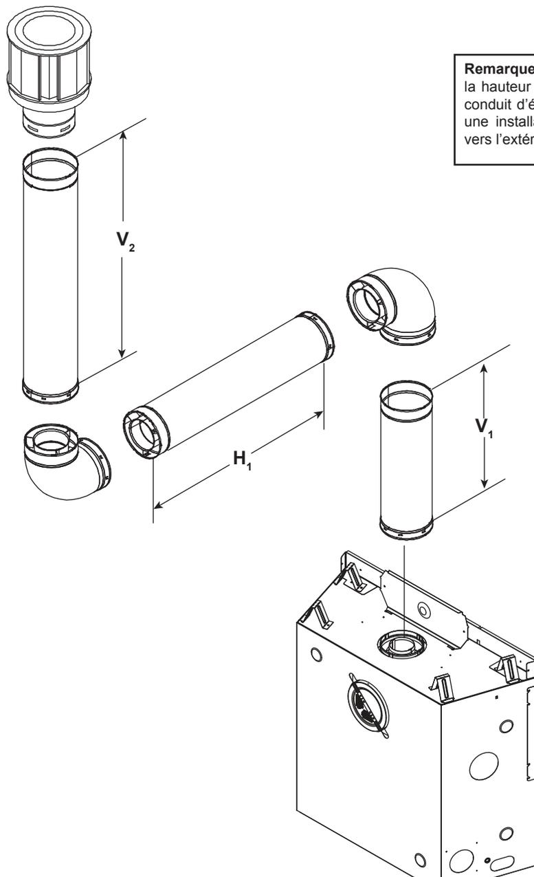
**Remarque :** On DOIT diminuer de 25 % la hauteur H totale quand on utilise un conduit d'évacuation flexible, sauf pour une installation simple vers le haut et vers l'extérieur. Voir la figure 4.8.
