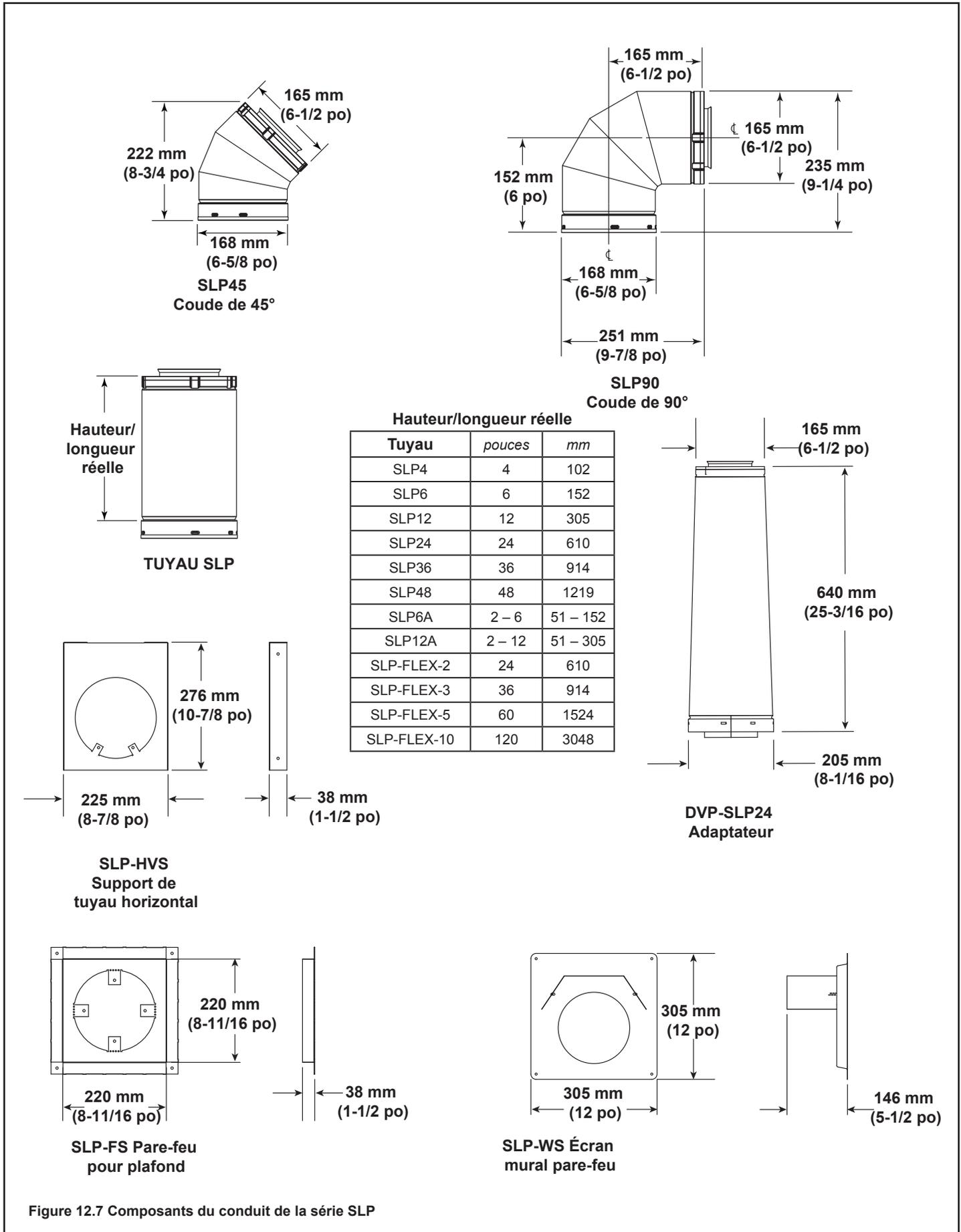
Figure 12.7 Composants du conduit de la série SLP
