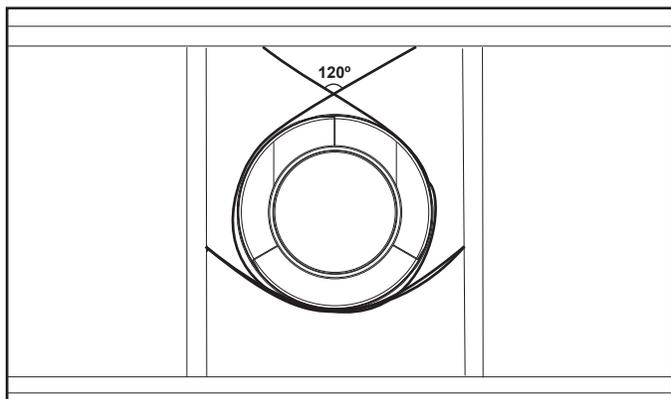
Figure 7.9 Fixation des sections horizontales du conduit
