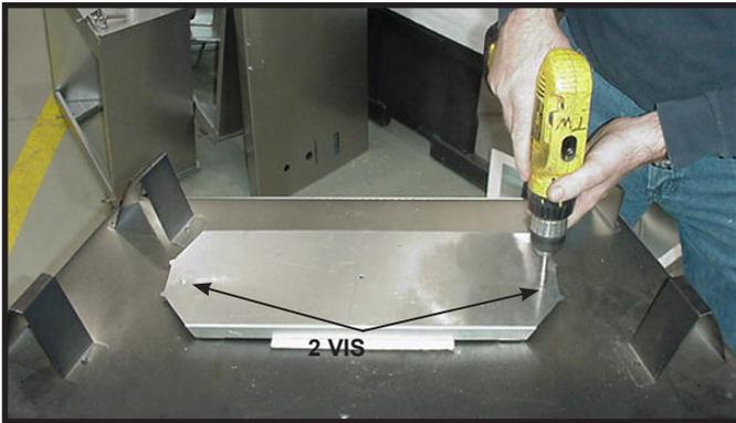
**Figure 6.1** Pour le conduit supérieur, retirez les deux vis maintenant en place l'écran thermique supérieur. Pour l'évacuation arrière, voir la page suivante.
