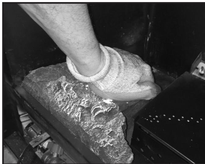
Figure 11.2 Appuyez sur l'âtre gauche solidement en place
