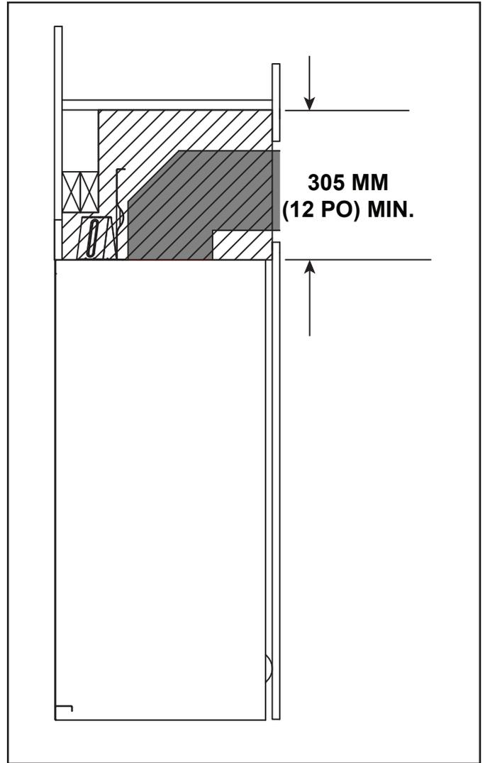
Figure 10.7 Zone incombustible au-dessus de l'appareil à évacuation supérieure
