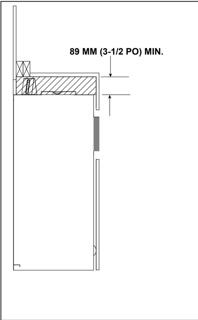
Figure 10.6 Zone incombustible au-dessus de l'appareil à évacuation arrière
