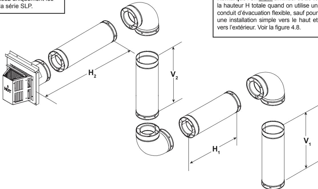
**Remarque :** On DOIT diminuer de 25 % la hauteur H totale quand on utilise un conduit d'évacuation flexible, sauf pour une installation simple vers le haut et vers l'extérieur. Voir la figure 4.8.
