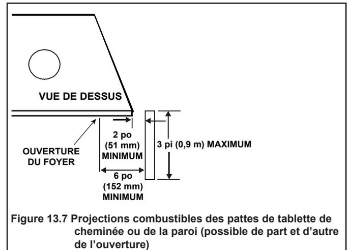
Figure 13.7 Projections combustibles des pattes de tablette de cheminée ou de la paroi (possible de part et d'autre de l'ouverture)
