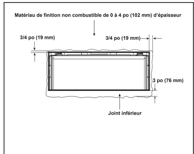
Figure 13.12 Matériau de finition de surface de 0 à 4 po (102 mm) d'épaisseur – méthode de pose encastrée (façade décorative Deco seulement)
