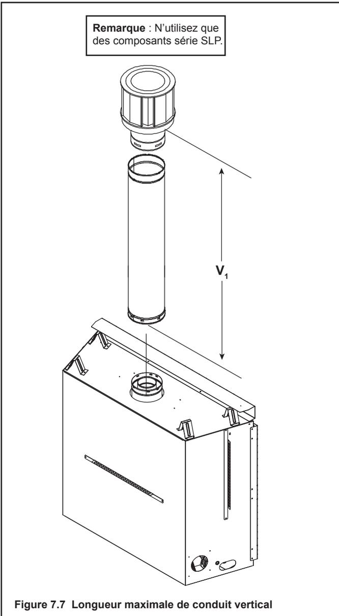
L'utilisation d'un réducteur d'échappement est recommandée pour les produits à abat-vent vertical qui produisent un appel d'air excessif. Le réducteur d'échappement compense l'appel d'air et restaure la hauteur visuelle des flammes. Si la configuration du conduit a une longueur verticale totale de 15 à 44 pi (4,6 à 13,4 m), un réducteur d'échappement peut être nécessaire. Le réducteur d'échappement se trouve dans le sac du manuel du propriétaire.
