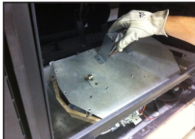
Figure 11.3. Déposez la plaque de vanne
