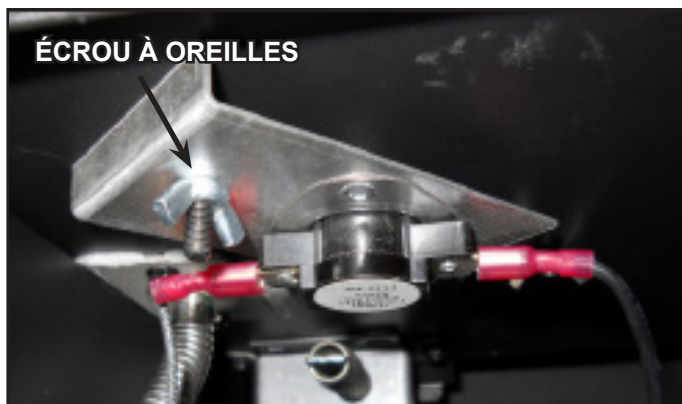
Figure 8.5 Interrupteur à capteur de température installé
