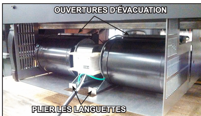
Figure 8.4 Logement du ventilateur
