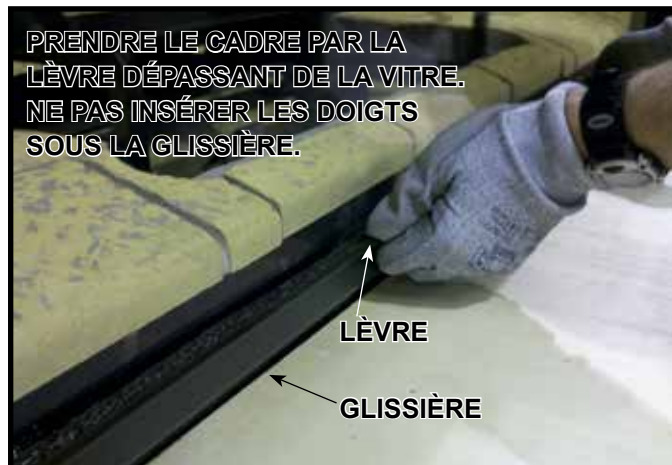
Figure 11.6. Installer la vitre
