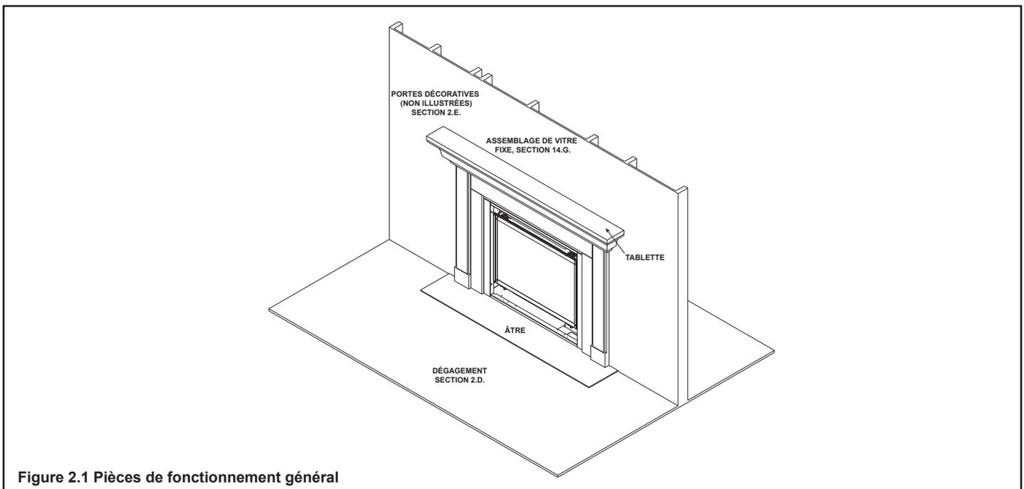
Figure 2.1 Pièces de fonctionnement général
