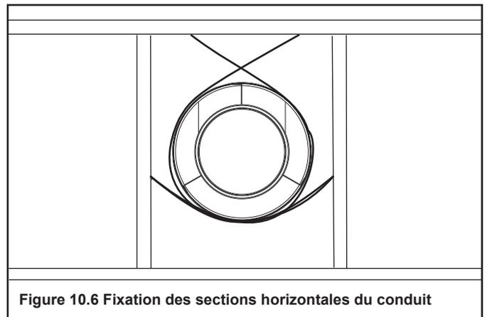
Figure 10.6 Fixation des sections horizontales du conduit
