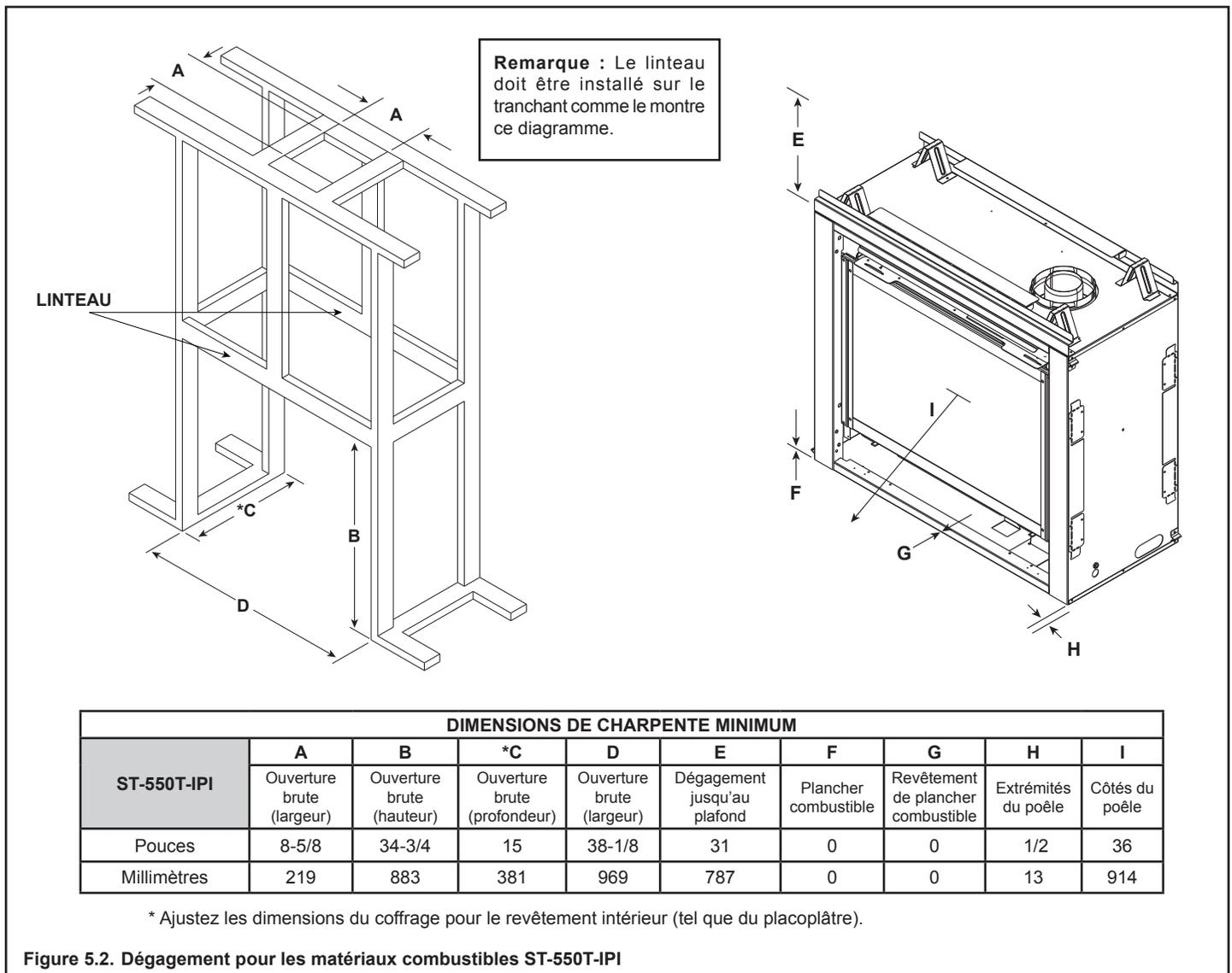
Figure 5.2. Dégagement pour les matériaux combustibles ST-550T-IP1
