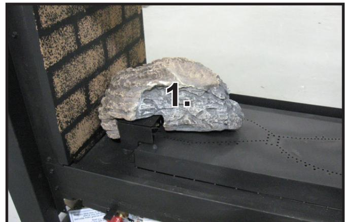
**ÉTAPE 2. Bûche 1 (SRV2126-700) :** Placez la bûche 1 de manière à ce que la grande entaille dans le fond de la bûche repose sur le bouclier de la veilleuse, comme le montre la Figure 4. Le trou dans le fond de la bûche 1 s'emboîte sur la tête de la vis de l'épaulement du brûleur.
