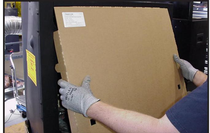
Figure 13.4 Installation du protecteur antiéclaboussure
