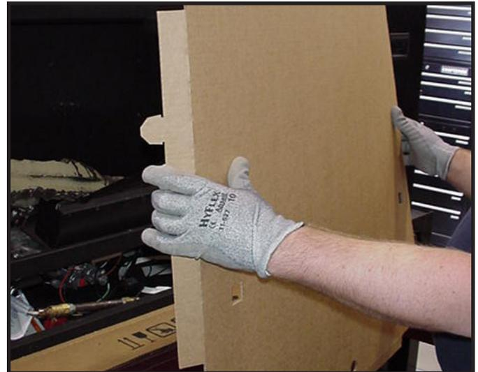
Figure 13.3 Pliage des côtés gauche et droit du protecteur antiéclaboussure
