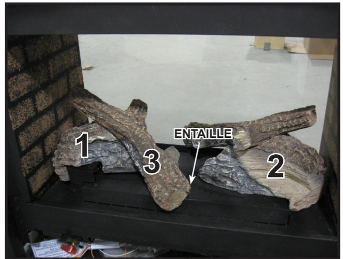
**ÉTAPE 5. Bûche 3 (SRV2126-702) :** Placez la bûche 3 restante (la seconde bûche identique) dans le foyer afin que le bas de la bûche repose dans l'entaille sur le rebord avant du bac de base. Placez le haut de la bûche 3 sur le haut de la bûche 1 afin de dissimuler le plat. L'ensemble complet de similibûches est montré à la Figure 11. Consultez le manuel du propriétaire du foyer pour des instructions sur la manière de placer les similibraises Mystic Embers et la laine minérale.
