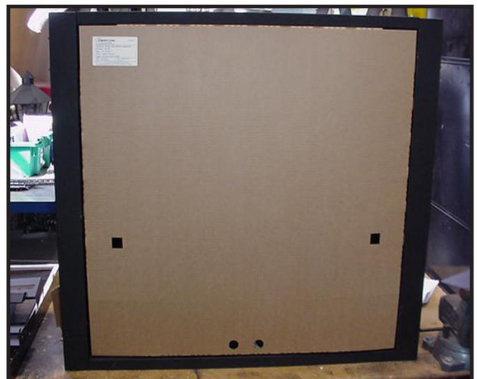
Figure 13.11 Protecteur antiéclaboussure avec le panneau d'accès inférieur fermé
