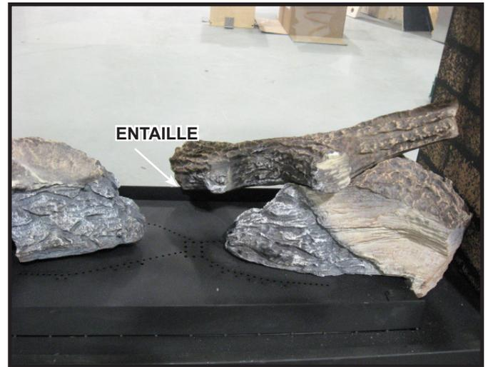
**ÉTAPE 4. Bûche 3 (SRV2126-702) :** Placez la bûche 3 (l'une de deux bûches identiques), comme le montre la Figure 7. Alignez le « Y » de la bûche 3 sur l'entaille de la bûche 2. Posez le bas de la bûche 3 sur l'entaille dans le rebord arrière du bac de base.
