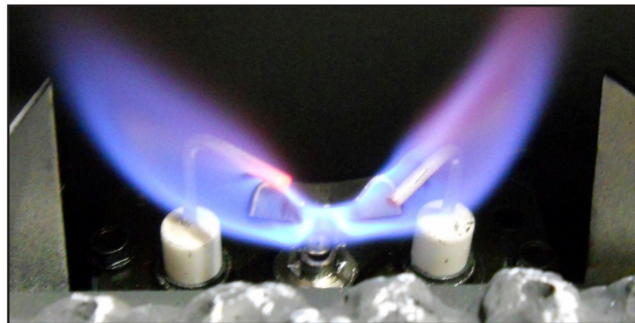
Figure 4.3 Forme de flamme de la veilleuse IPI
