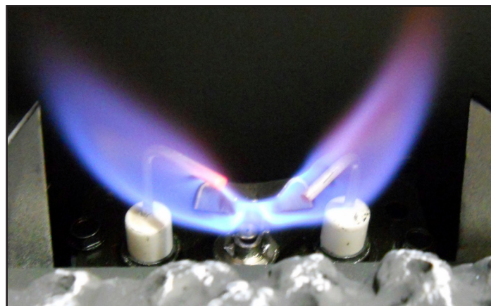
Figure 4.3 Forme de flamme de la veilleuse IPI
