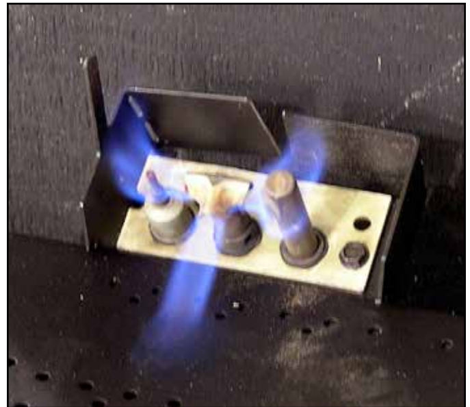
Figure 3.1 Modèle de flamme de la veilleuse permanente
