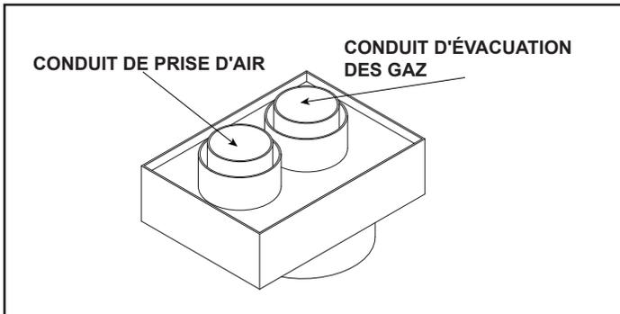
Figure 4.29 Connecteur de poêle coaxial/colinéaire
