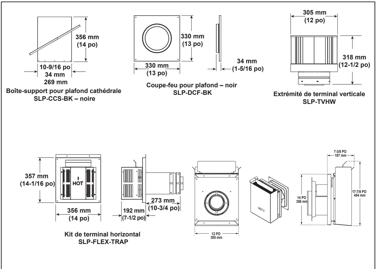
Figure 11.3 Composants du conduit de la série SLP
