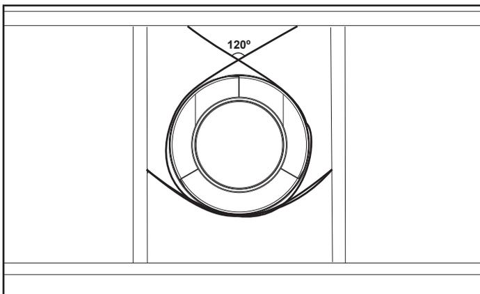
Figure 7.6 Fixation des sections horizontales du conduit
