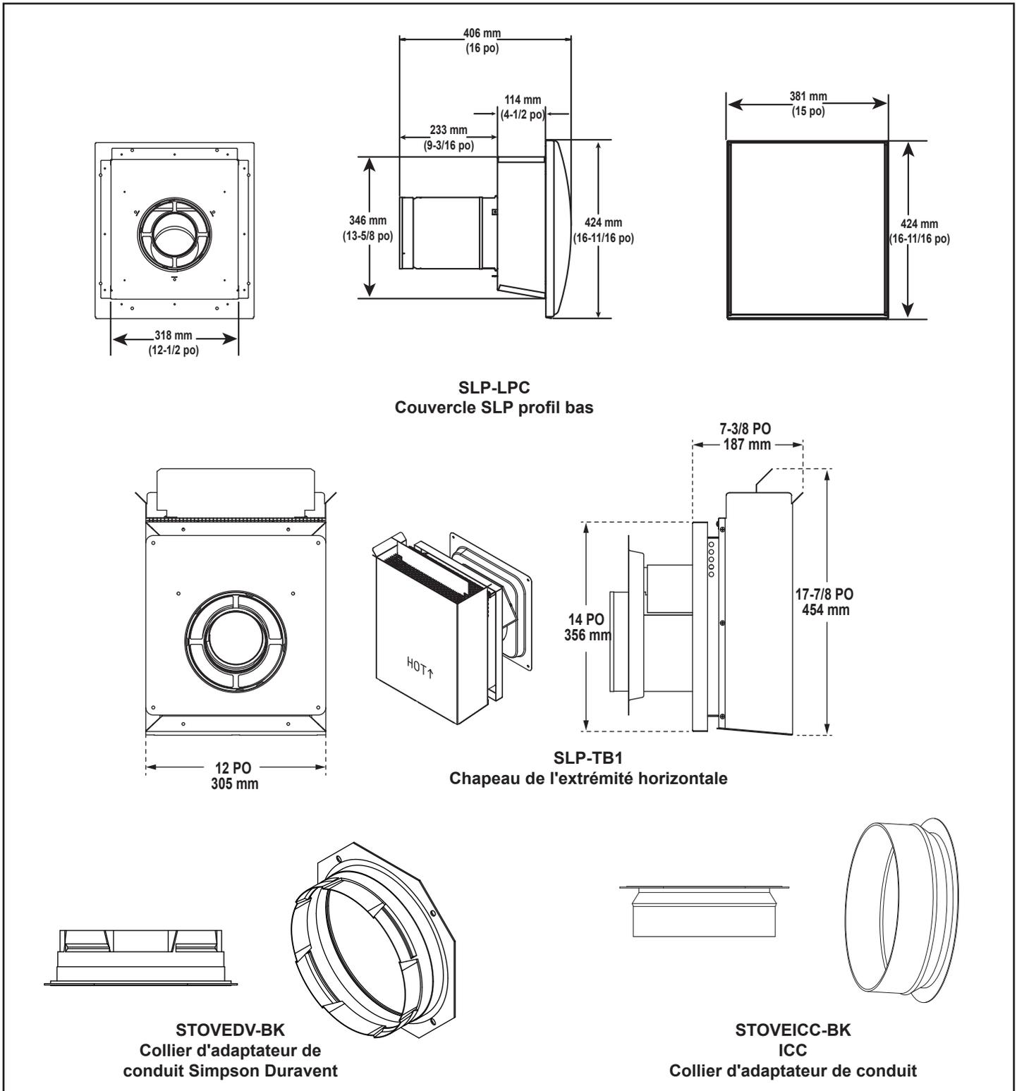
Figure 11.4 Composants du conduit de la série SLP
