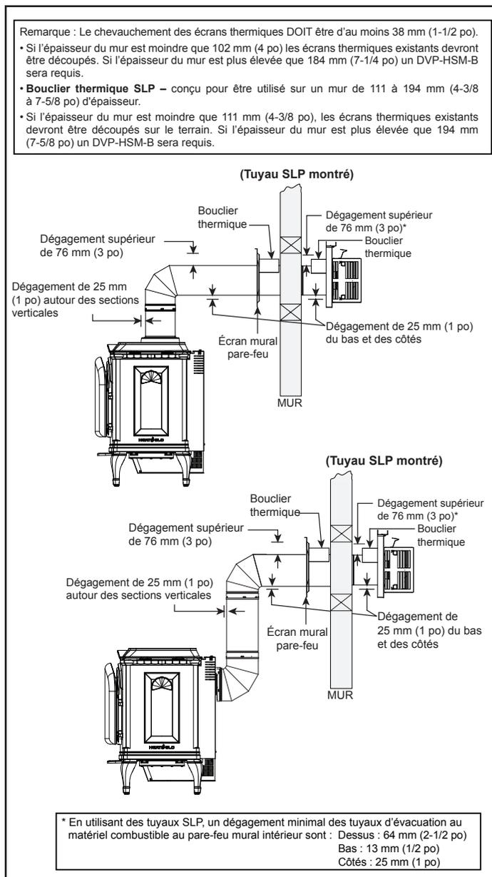
Figure 5.1 Dégagements des conduits d'évacuation horizontaux par rapport aux matériaux combustibles
