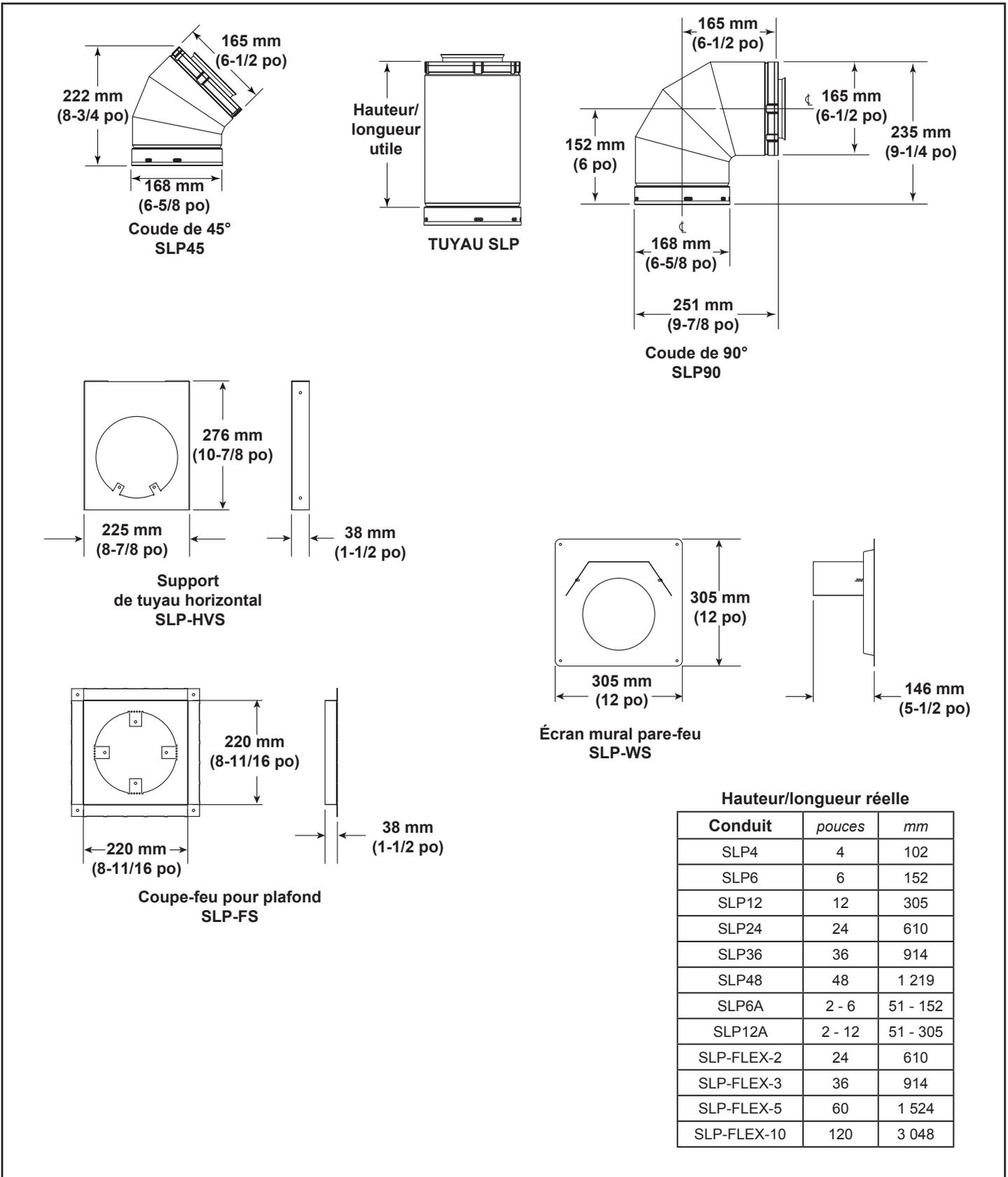
Figure 11.1 Composants du conduit de la série SLP
