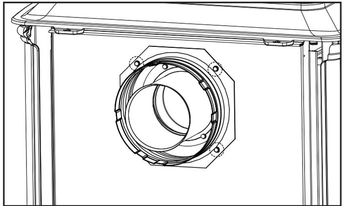
Figure 6.9. Réattacher le collier de départ/le joint
