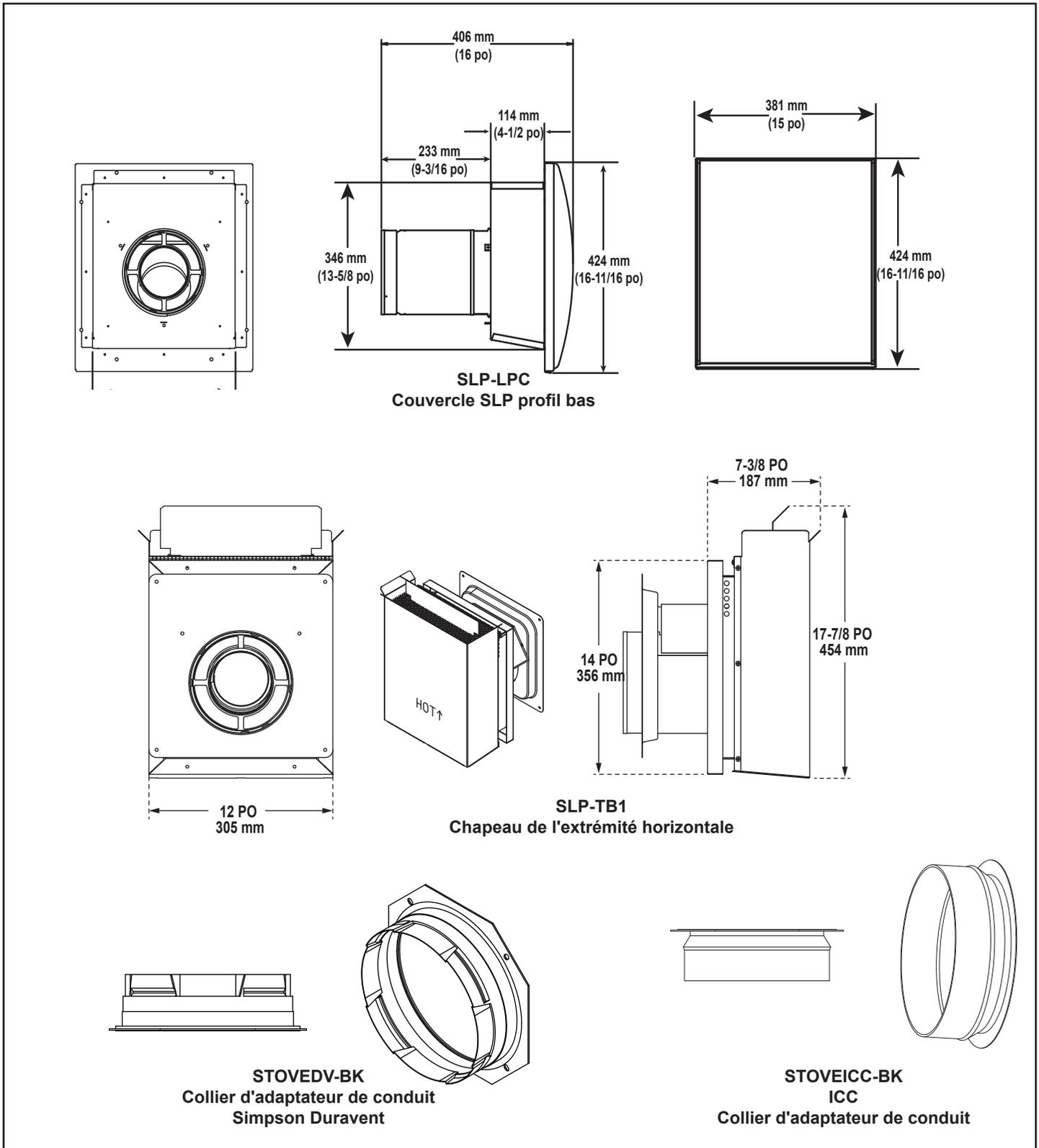
Figure 11.4 Composants du conduit de la série SLP
