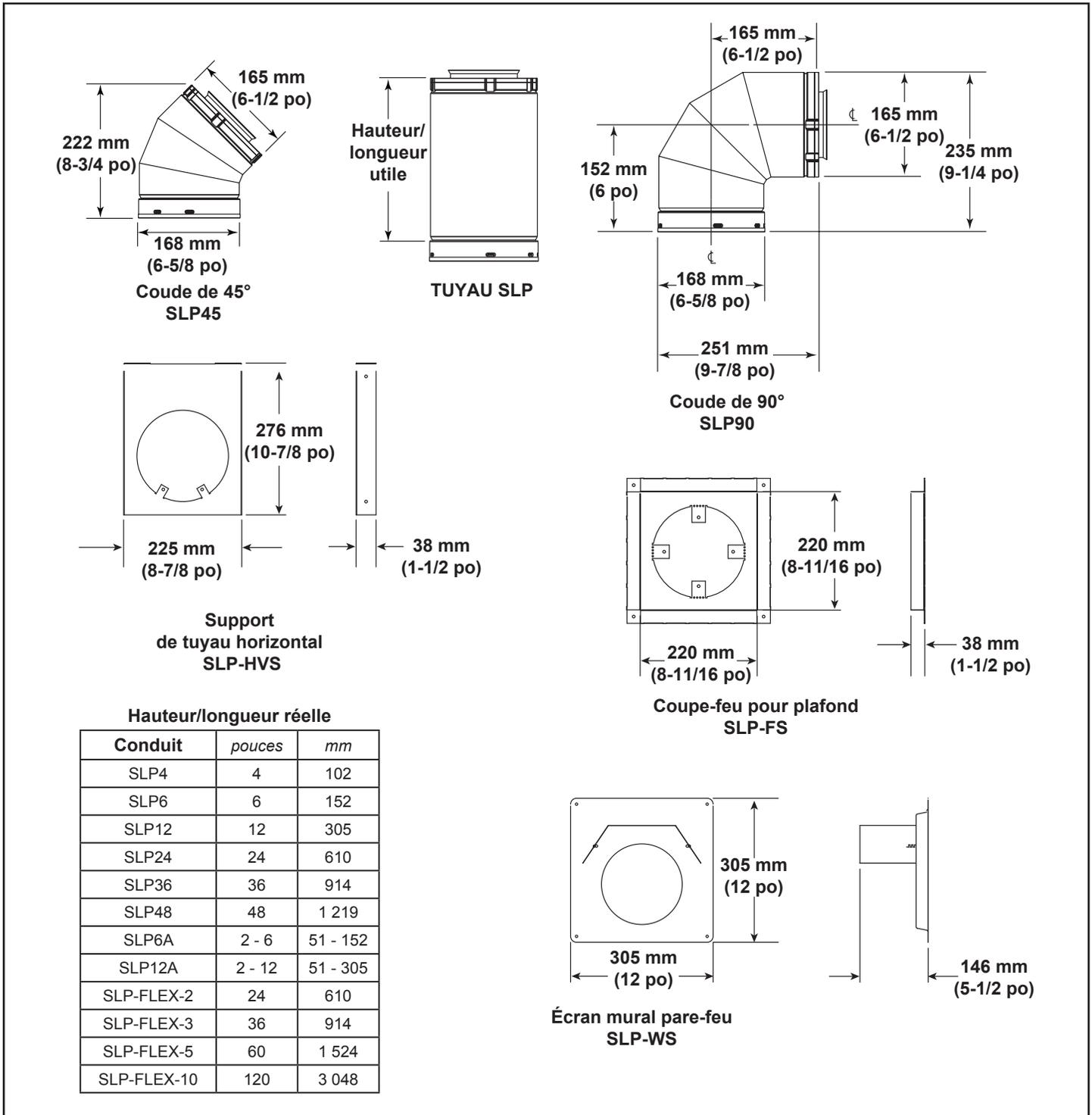
Figure 11.1 Composants du conduit de la série SLP
