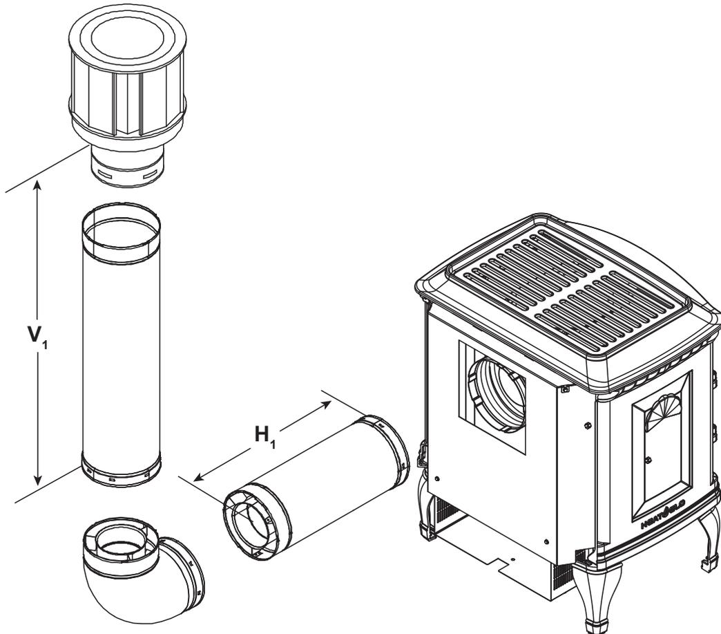
**Remarque :** Un orifice de délestage est requis avec cette configuration et est inclus avec l'ensemble d'évacuation arrière.
