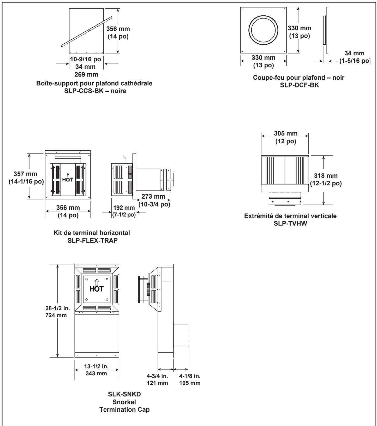
Figure 11.3 Composants du conduit de la série SLP
