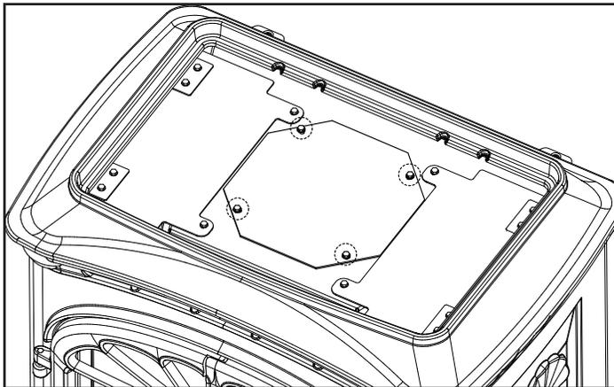
Figure 6.6. Réattacher la plaque d'accès arrière/le joint
