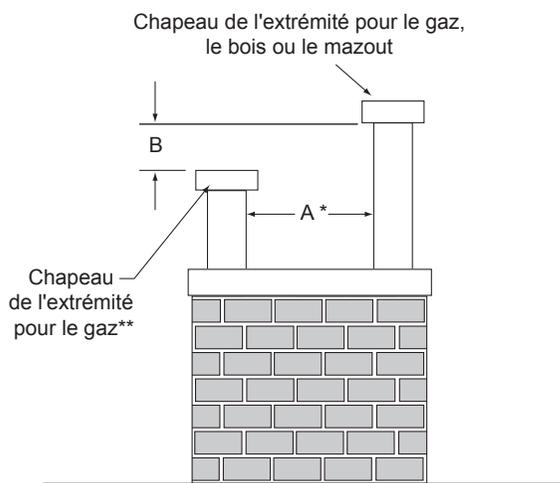
\* Si un couvercle d'extrémité décoratif est utilisé, la distance pourrait devoir être augmentée. Se reporter aux instructions d'installation fournies avec le couvercle d'extrémité décoratif.
