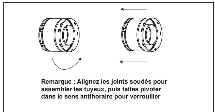
Figure 7.2 Ajout de composants au conduit d'évacuation
