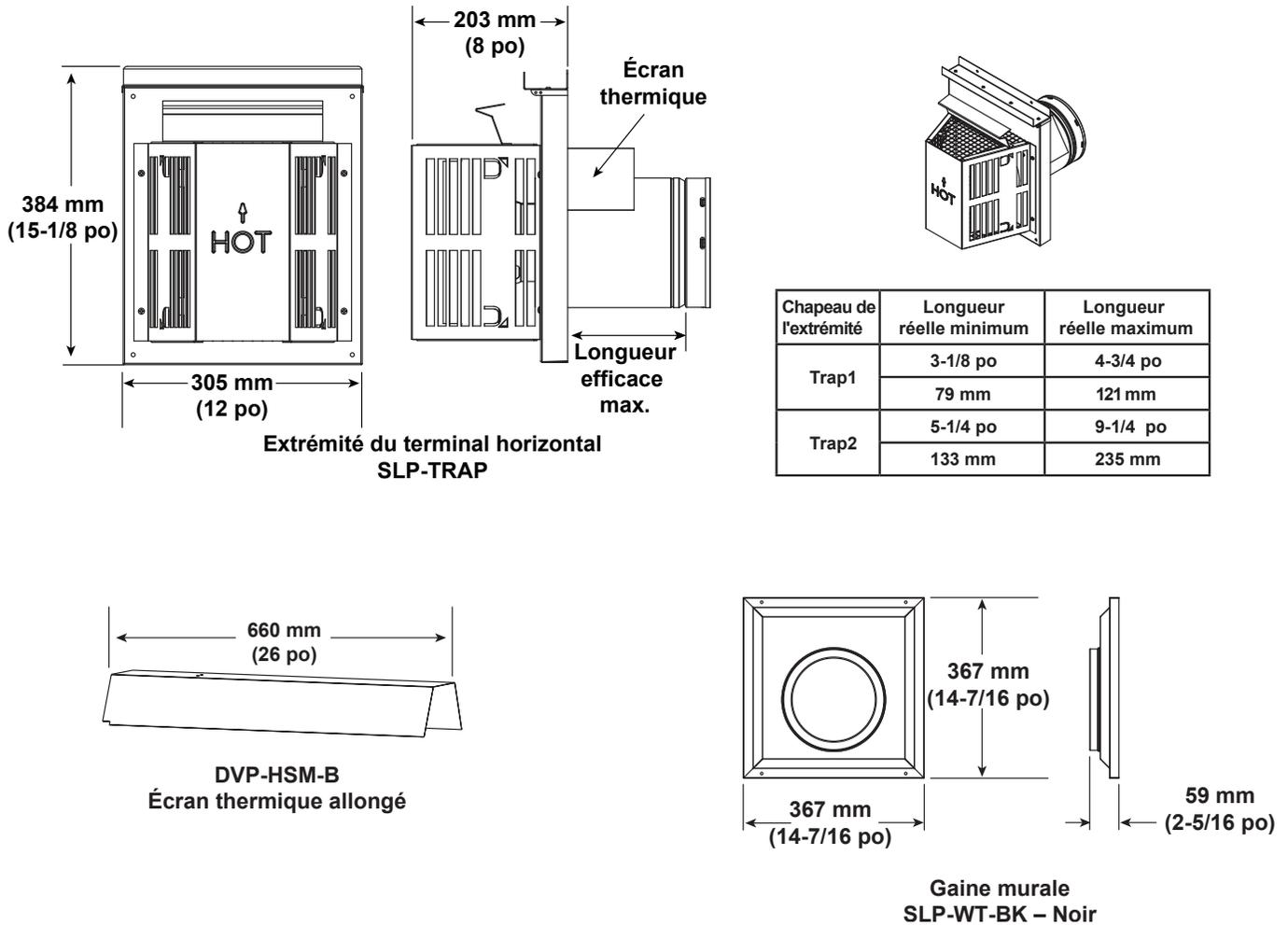
Figure 11.2 Composants du conduit de la série SLP
