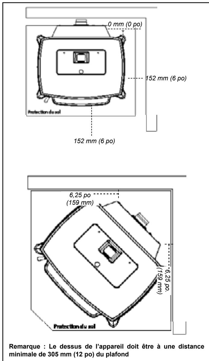
Remarque : Le dessus de l'appareil doit être à une distance minimale de 305 mm (12 po) du plafond
