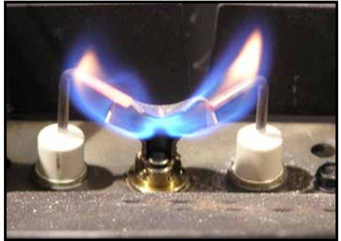
Figure 3.1 Modèles de flamme de la veilleuse IPI
