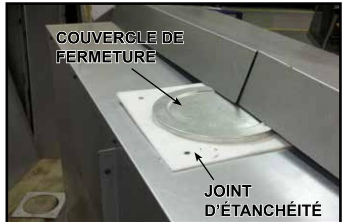
Figure 9.2 Emplacement du joint d'étanchéité et du couvercle de fermeture
