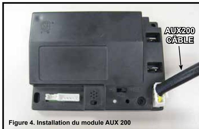
Figure 4. Installation du module AUX 200
