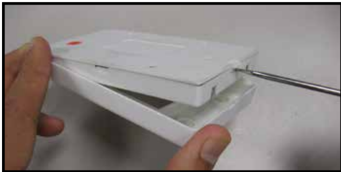
Figure 1. Démontage de l'interrupteur mural
