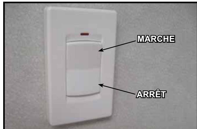
Figure 4. Fonction de l'interrupteur RC100
