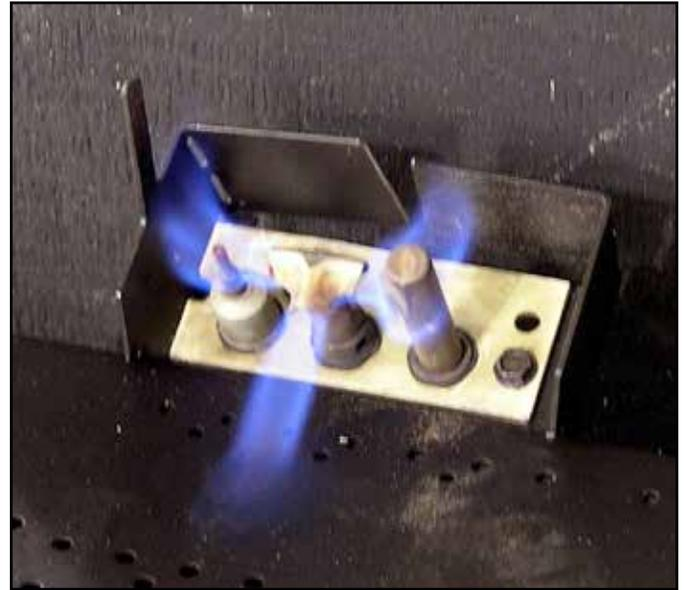
Figure 3.1 Modèle de flamme de la veilleuse permanente
